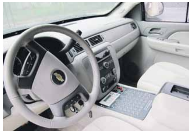
▶ Пултът за управление на МАРС е на мястото на скоростния лост
